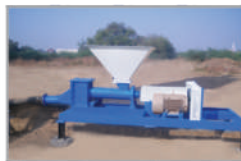
Cement / Fly ash debagging system
